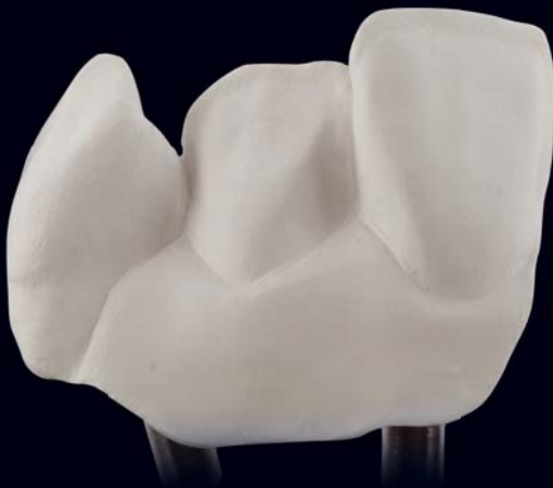
^ 08 Zirkonoxid-Brücke nach dem Fräsen
